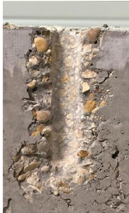
Furattisztítás TE-CD/TE-YD fúrószárral
